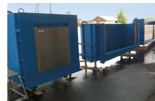
Um einheitliche Prüfbedingungen zu schaffen, wurden spezielle Prüfcontainer entwickelt. Hier wurden drei Prüfboxen des EVH in drei Größen für den Einsatz bereitgestellt.
