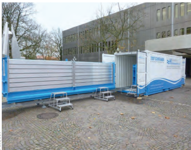
Prüfcontainer des EVH mit ausgefahrener großer Box
