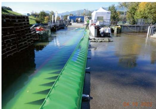
**Bilder 1 und 2** Geprüfte Schutzsysteme der Gruppen K3 (links) und K4 (rechts)
