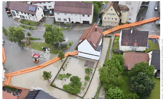
Bild 1 Aufgebauter Schlauchdamm (orange) in einem Wohngebiet
